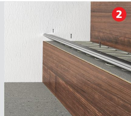
**BASIS-Profil zuschneiden, mit der Anschlagkante an den Bodenbelag schieben, die Bohrlöcher markieren, bohren, dübeln und dann verschrauben. Kleber auftragen und den Bodenbelag verkleben. Dehnfuge berücksichtigen.**
