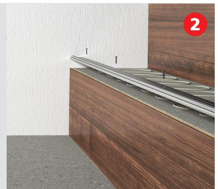
TOP-Profil zuschneiden, dabei auf die passgenaue Ausrichtung der längeren Schenkel vom TOP-Profil zur Verschiebenut des BASIS-Profils achten. TOP-Profil klicken. Fertig ist die sichere Stufenkante.
