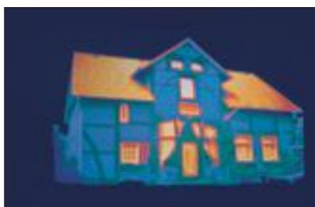
Teplotní obrázek domu. Světlá místa zobrazují velké tepelné ztráty.
